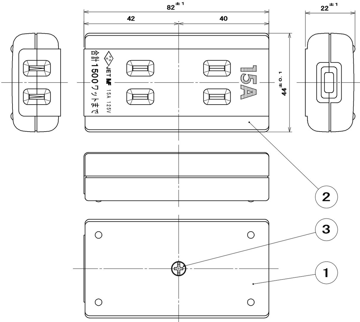
適用電線：保護被覆付ビニル平形コード(VFF) 2mm<sup>2</sup> 2心
