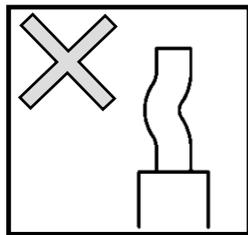
器具裏面の電線穴に心線を奥まで1本ずつ確実に差し込んでください。
